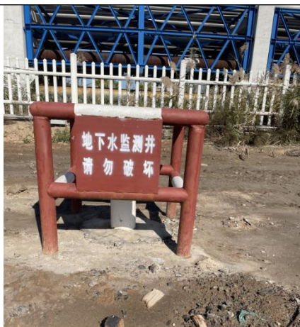
地下水监测井
